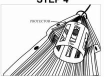
THE WIRE IS ADJUSTED ALONG WITH THE PROTECTOR IN THE CENTER OF THE LAMP.
