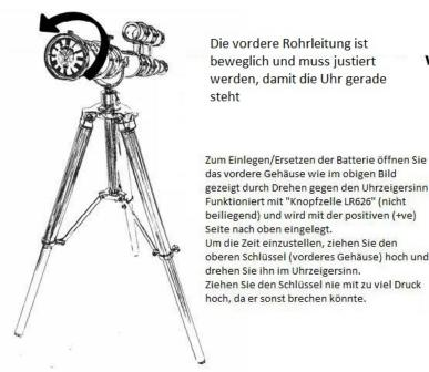
Die vordere Rohrleitung ist beweglich und muss justiert werden, damit die Uhr gerade steht
