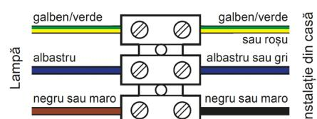
În cazul anumitor lămpi conductorul de protecție nu trebuie conectat la o bornă, ci la clema de la componente metalice ale lămpii (șurub cu simbolul de pământare ⊕).
