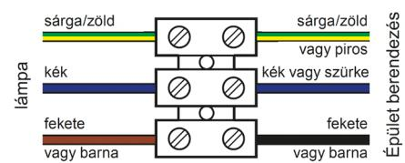
Bizonyos lámpák esetében a védővezetéket nem egy csiptetőhöz hanem a lámpa fém alkatrészeinek egyik csiptetőjéhez kell csatlakoztatni (csavar földelés szimbólummal ☷).
