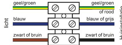
Bij een aantal lampen moet de aardleiding niet worden aangesloten op een klem, maar op een klem van de metalen delen van de lamp (scherf met aardingssymbool
